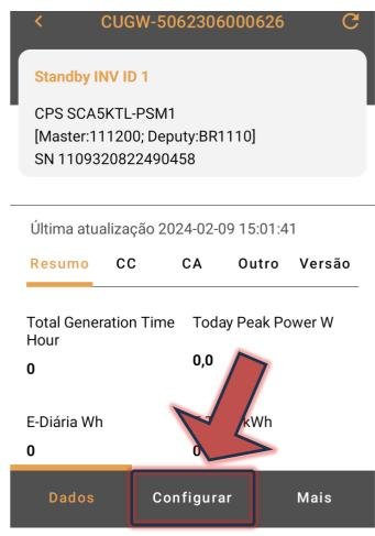
6° Passo: Temos agora quatro opções. Para configurar o inversor de maneira rápida e básica, clique em "Configure o inversor". Para uma configuração mais avançada, onde é possível por exemplo alterar o nível máximo de tensão, clique em "Registro de leitura/gravação".
